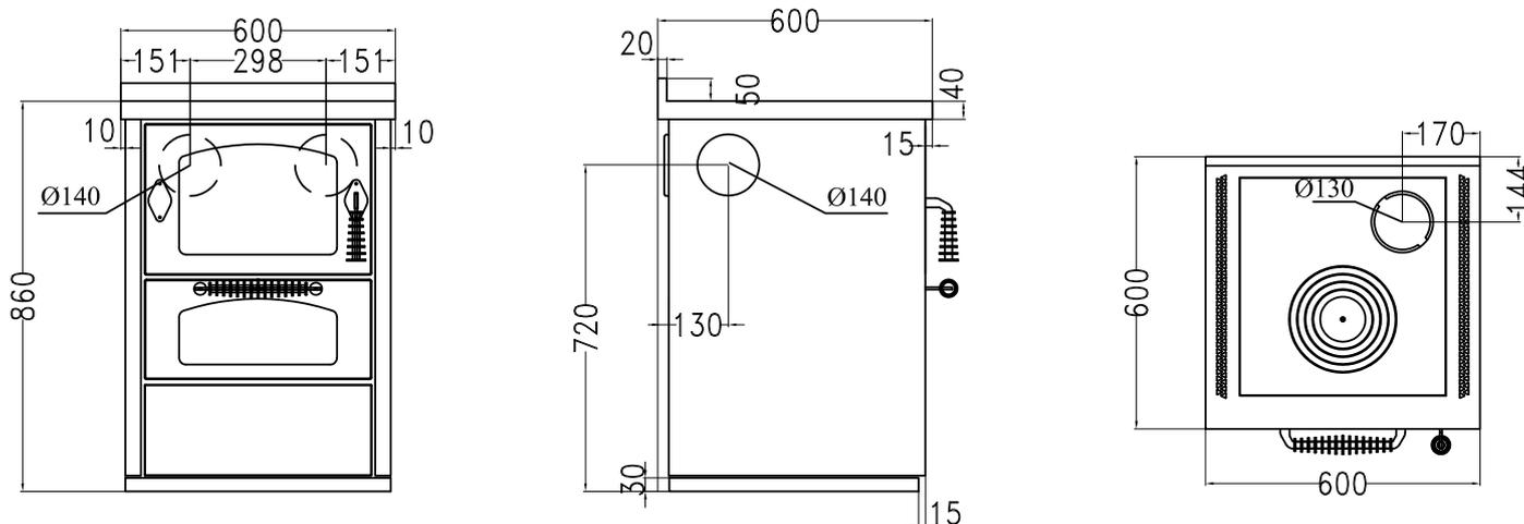
Versione con uscita fumi a destra. La versione con uscita fumi a sinistra è simmetrica.
